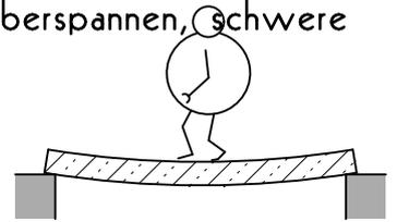
Biegung Stahlbetonbalken werden hauptsächlich auf Biegung beansprucht.
