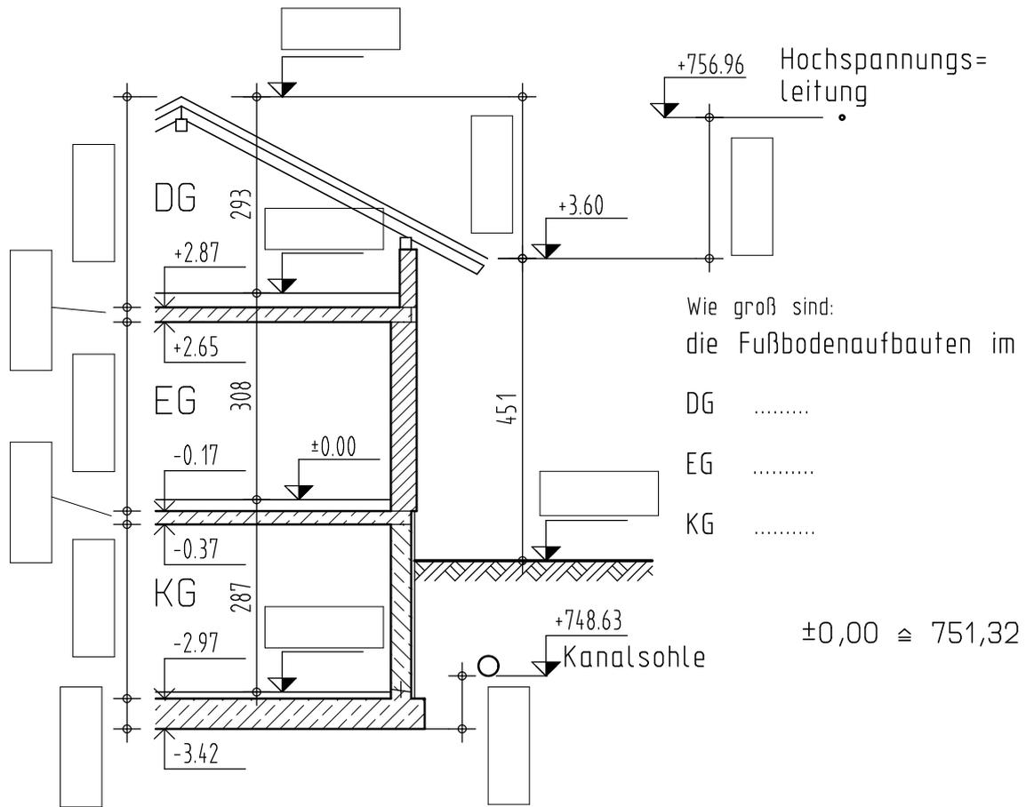
Berechnen Sie alle offenen, mit Rechteck gekennzeichneten Höhenmaße. Tragen Sie die Werte in die vorgesehenen Kästchen ein. Einheiten beachten - Maßlinien in cm, Höhenkoten in m mit Vorzeichen.
